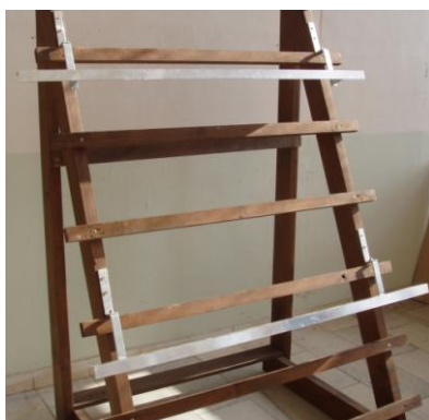
Montáž hliníkových profilů Rozteč pro VS 10 1400 – 1600 mm
